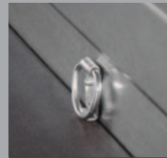
Anbindepunkte King (Standard) DIN 750 daN (kg)
