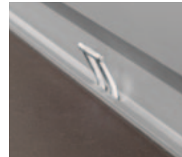
1 Anbindepunkte in V-Profil (Standard) DIN 400 daN (kg)
