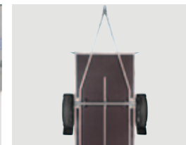
8 Durchgehende Deichsel und zusätzliche Träger
