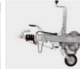
5 Automatikstützrad (Option bei V-Deichsel)
